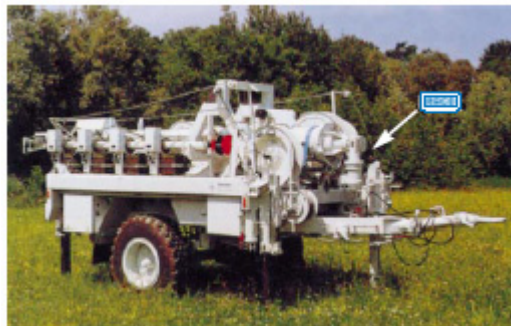
拖车安装式天线杆 运输模式
